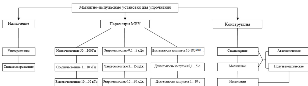
Рисунок 1. — Классификация магнитно-импульсного оборудования для упрочнения стальных изделий
