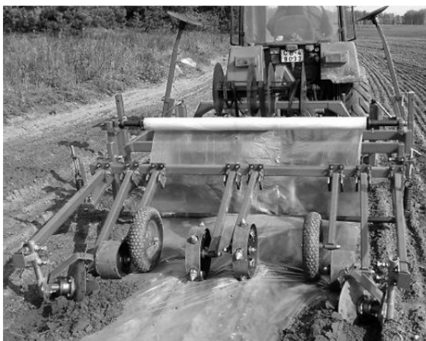
Рисунок 2. — Процесс работы пленкоукладчика УПТ-1
