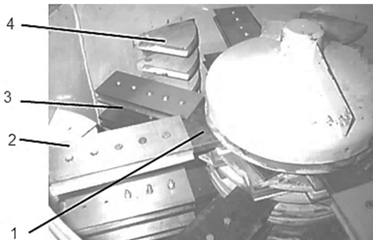
1 — державка; 2 — верхний нож; 3 — нижний нож; 4 — противорежущий элемент
