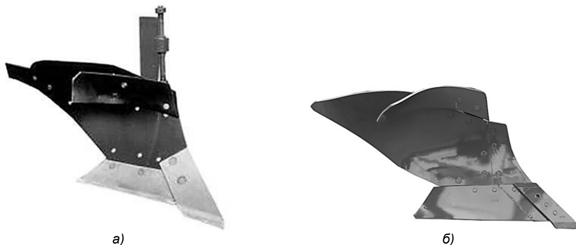
Рисунок 1. — Плужные корпуса с углоснимами: а — ПЛП-01 производства ОАО «Минский завод шестерен»; б — типа МХ плуга UNIA IBIS XM 4+1 (Польша)
