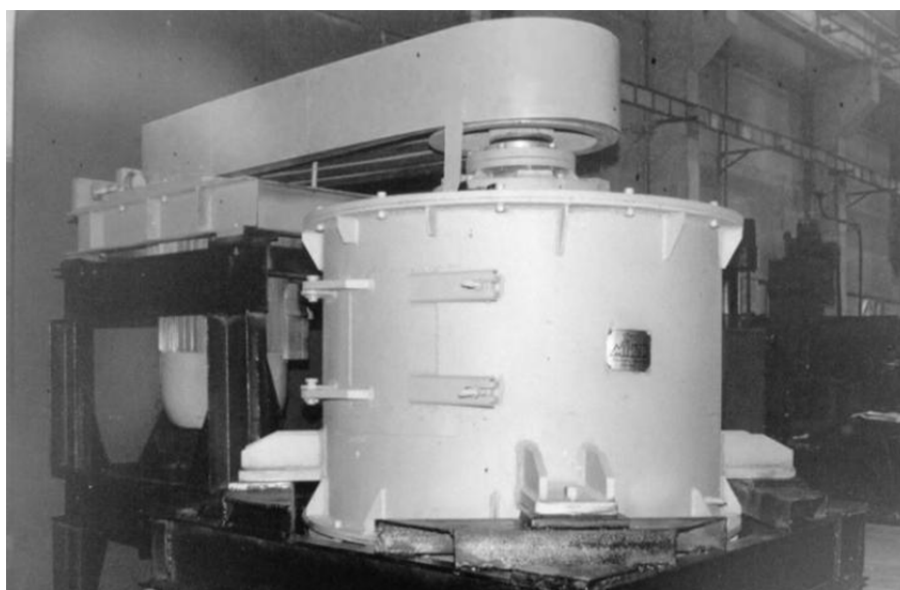
Рисунок 1. — Промышленная дробильная установка ударного действия с вертикальным валом для получения кубовидного щебня
