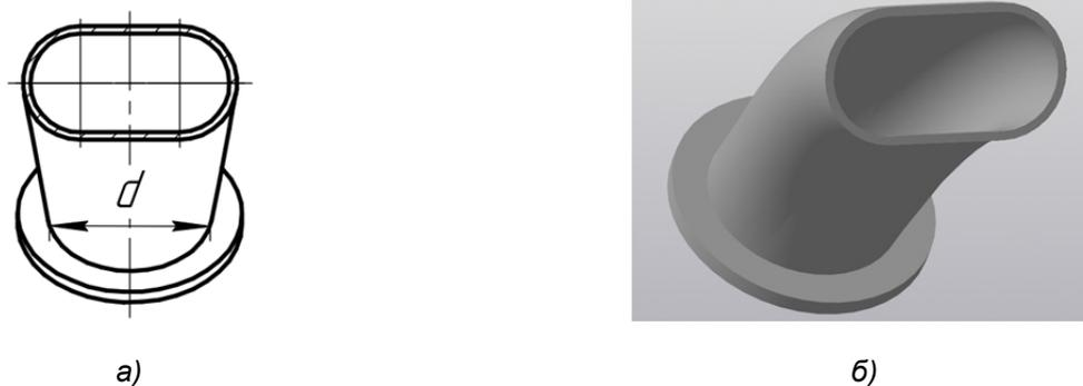
**Рисунок 2. — 3D-модель предложенной (овальной) формы поперечного сечения поворотного участка: а — схема поперечного сечения колена овальной формы; б — компьютерная 3D-модель колена овальной формы**
