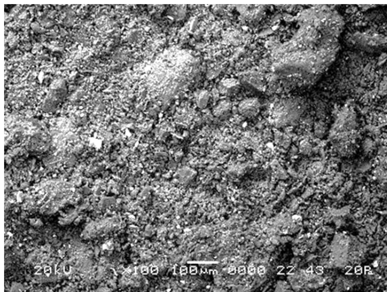
Рисунок 6. — Электронно-микроскопическое изображение структуры образца бурого угля (без предварительного фракционирования) после измельчения в течение 15 мин
