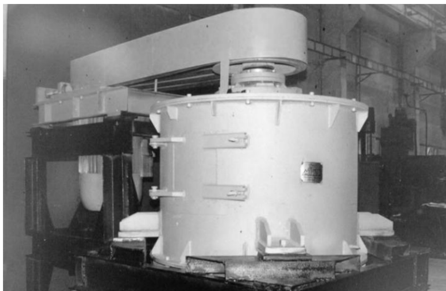
Рисунок 1. — Промышленная дробильная установка ударного действия с вертикальным валом для получения кубовидного щебня
