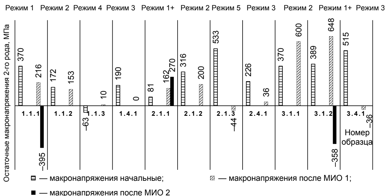
Рисунок 2. — Суммарное остаточное макронапряжение 2-го рода образцов магниевого сплава AZ80 до и после МИО при режимах 1—5
