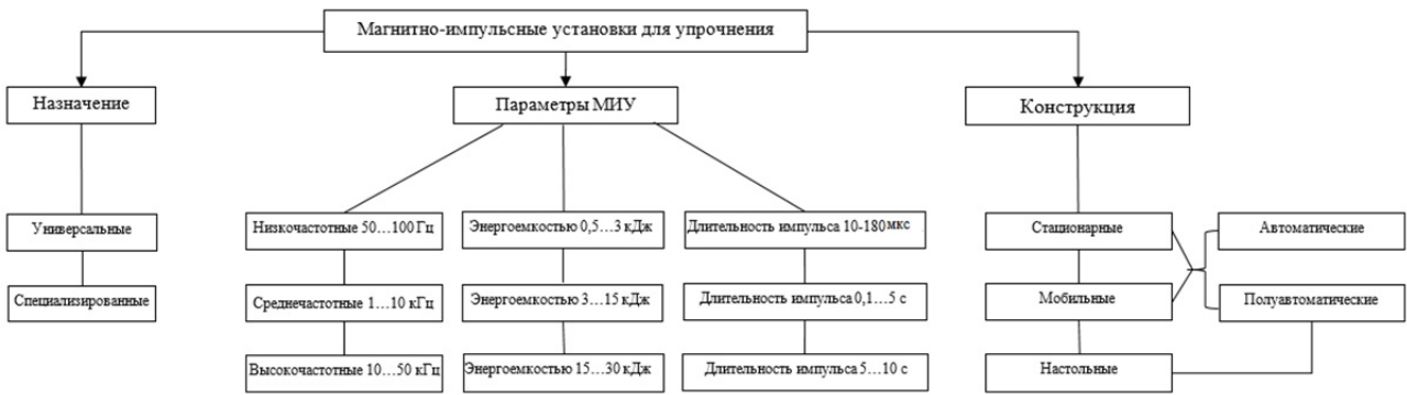
Рисунок 1. — Классификация магнитно-импульсного оборудования для упрочнения стальных изделий
