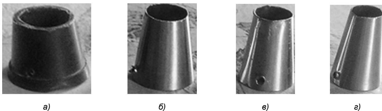
Рисунок 1. — Модели конических кожухов: а —  $d_c = 25$  мм,  $\alpha = 35^\circ$ ; б —  $d_c = 20$  мм,  $\alpha = 35^\circ$ ; в —  $d_c = 20$  мм,  $\alpha = 30^\circ$ ; г —  $d_c = 15$  мм,  $\alpha = 30^\circ$
