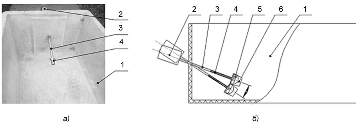
1 — емкость; 2 — привод мешалки; 3 — труба; 4 — кожух; 5 — вал; 6 — мешалка
