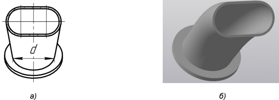
Рисунок 2. — 3D-модель предложенной (овальной) формы поперечного сечения поворотного участка: а — схема поперечного сечения колена овальной формы; б — компьютерная 3D-модель колена овальной формы
