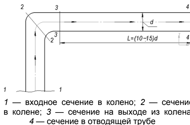
Рисунок 8. — Схема исчезновения «парного вихря» на выходе из колена
