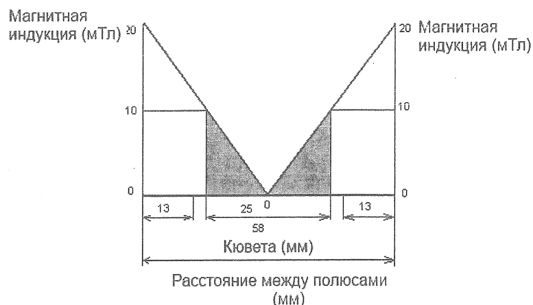
Рисунок 4 — Распределение магнитной индукции между полюсами электромагнитов и на их полюсах (затемнённая часть соответствует кювете с ферромагнитным порошком)
