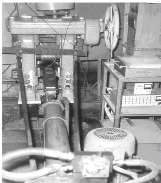
**Рисунок 7. — Установка для периодической прокатки полосовых заготовок**
