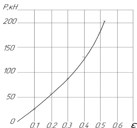
Рисунок 9. — Зависимость усилия продвижения оправки от степени деформации
