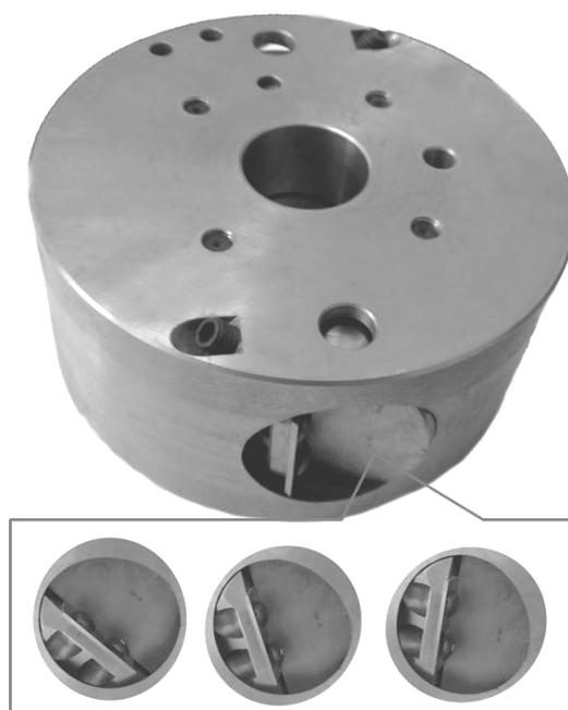
Рисунок 1. — Фреза сборная с изменяемыми углами передним и наклона кромки
