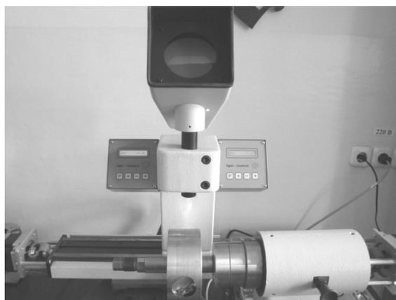
Рисунок 4. — Измерение угла наклона кромки на установке OptiControl
