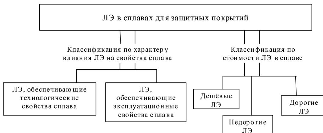
Рисунок 1 — Классификация ЛЭ в наплавочных сплавах для ЗП
