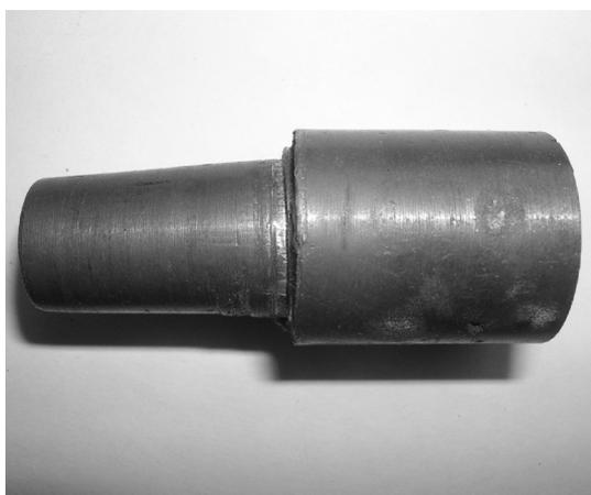
Рисунок 4 — ЭКС, восстановленный разработанными сплавами
