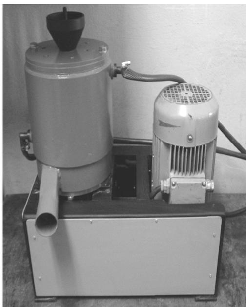
Рисунок 2 — Фотоснимок мельницы RTM4
