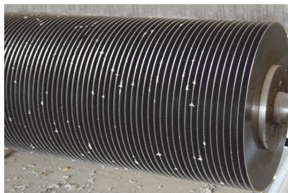
Рисунок 3. — Вал хлопкоочистительной машины с набором зубчатых дисков
