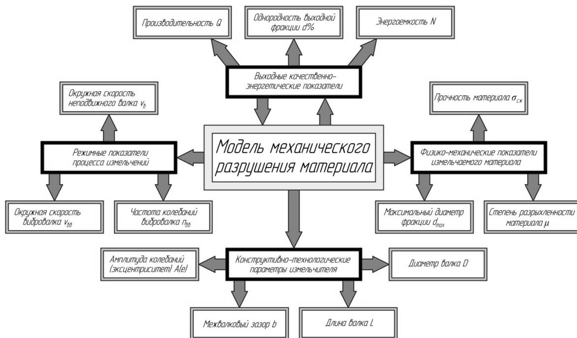
Рисунок 1. — Модель механического разрушения материалов
