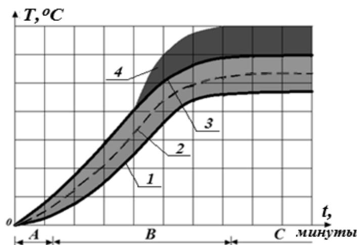
1 — нормативная температура агрегата; 2 — допустимая температура агрегата; 3 — критическая температура агрегата; 4 — потенциально опасная температура агрегата
