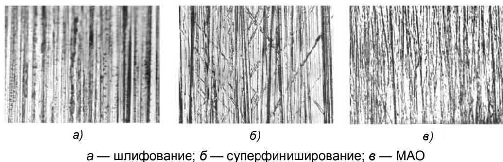
Рисунок 4. — Топография поверхности стали 12Х2Н4А после финишной обработки. ×150
