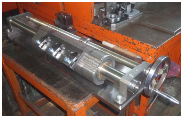
Рисунок 4. — Устройство для заточки геликоидальных рубильных ножей с ручным управлением
