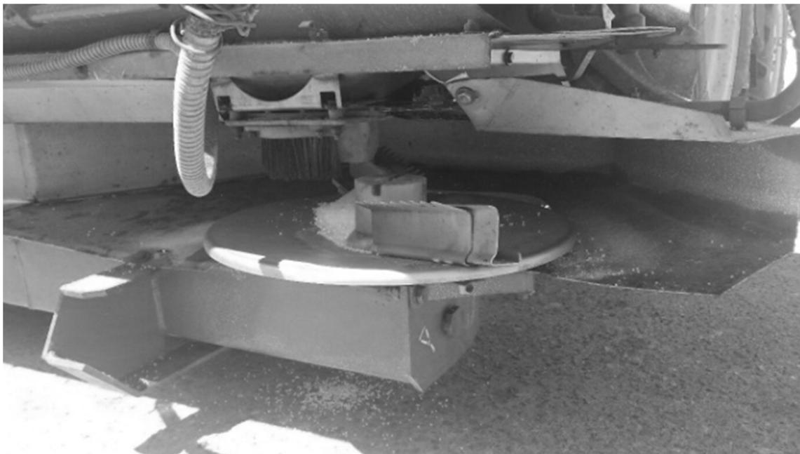
Рисунок 2. — Разбрасывающие диски дискового разбрасывателя удобрений (вид сбоку)
