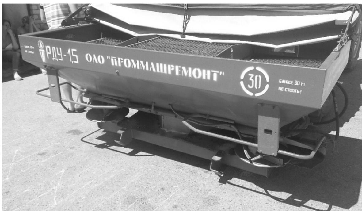
Рисунок 1. — Общий вид разбрасывателя удобрений РДУ-1,5
