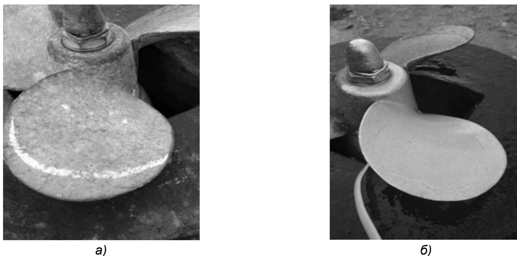
Рисунок 2. — Внешний вид лопастей гребного винта: а — поверхность до обработки; б — обработанная поверхность
