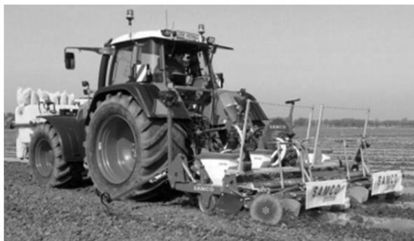
**Рисунок 5. — Сеялка SAMCO 41HD**
