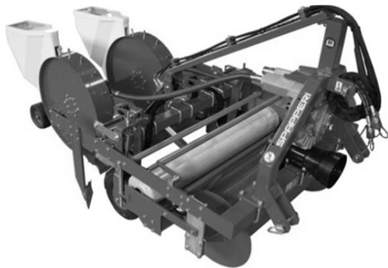
**Рисунок 8. — Комбинированная машина для посева с мульчированием пленкой Spapperi SMP**
