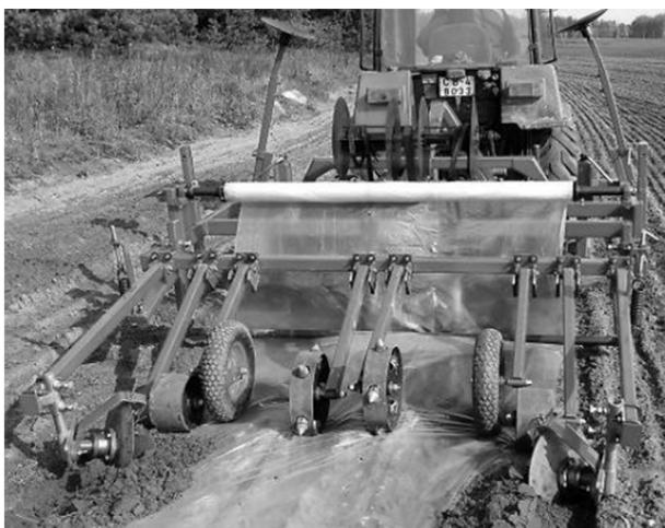
Рисунок 2. — Процесс работы пленкоукладчика УПТ-1
