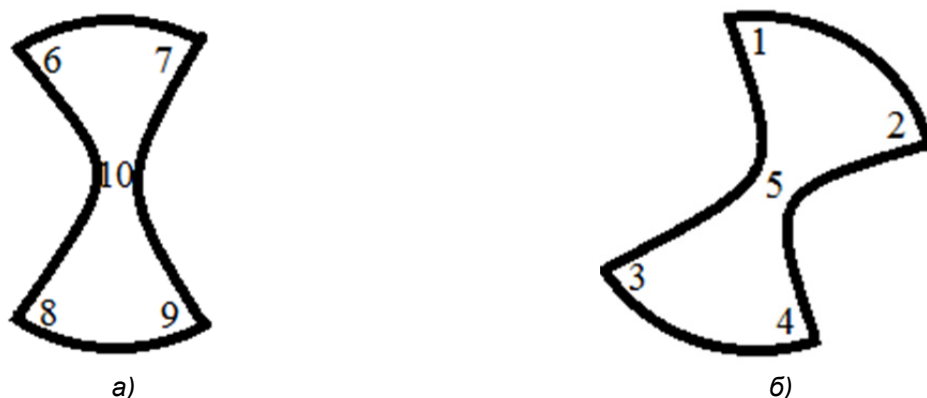
1, 4, 6, 9 — ленточка (режущая кромка); 2, 3, 7, 8 — спинка; 5, 10 — канавка
