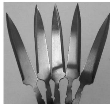
Рисунок 1. — Заготовки ножа универсального НУС-1 (ОАО «Красный металлист»)
