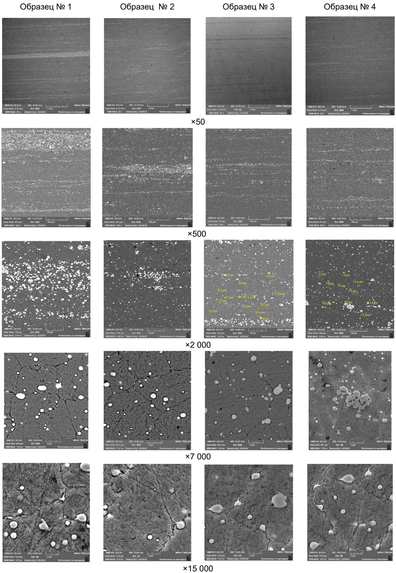
Рисунок 2. — Структура образцов № 1...4 из стали P6M5 в продольном сечении
