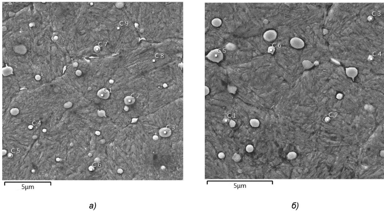
**Рисунок 4. — Структура образца № 1 из Р6М5 при ×7 000 на разных участках (а) и (б)**
