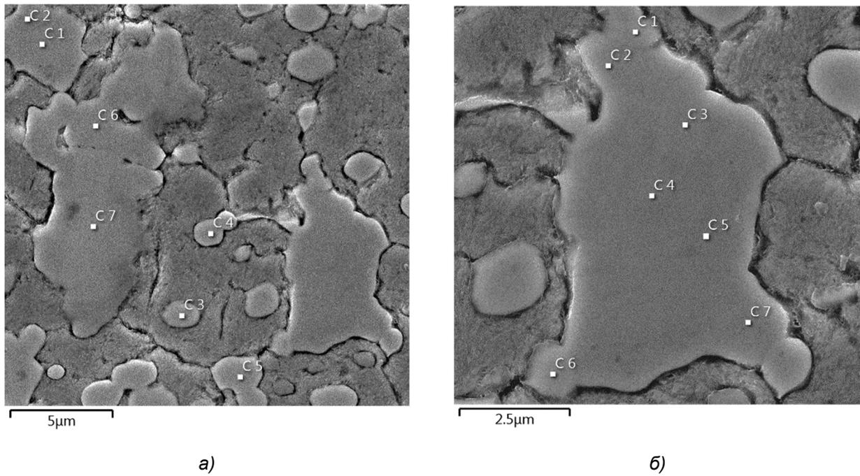
**Рисунок 5. — Структура образца № 1 из P6M5
