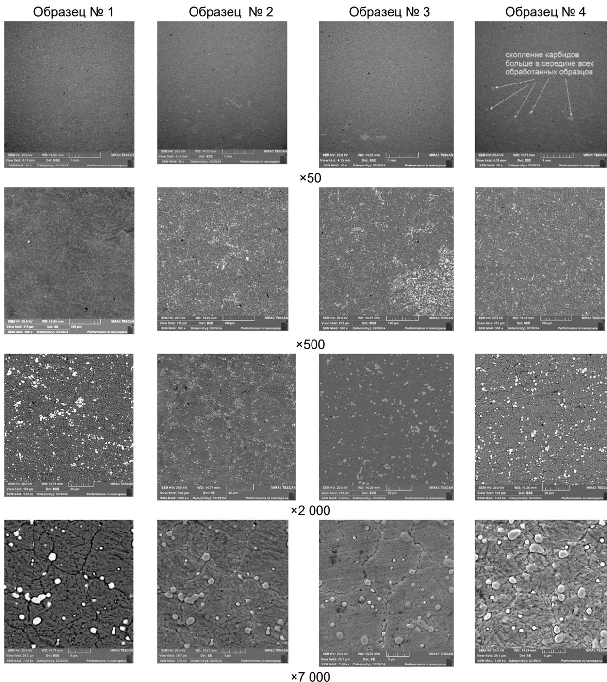
Рисунок 3. — Структура образцов № 1...4 из P6M5 в поперечном сечении
