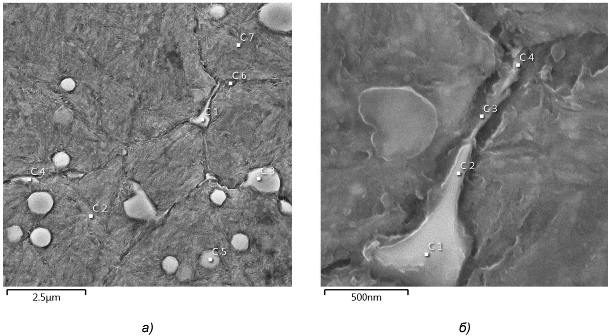
**Рисунок 7. — Структура образца № 3 из P6M5 при ×15 000 (а), ×80 000 (б)**
